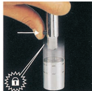
Wciśnij ponownie aby swobodnie wyjąć trzpień z nasadki
